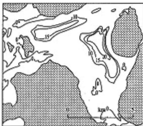
図4.5.3 瀬戸内海形成以降の堆積物層厚分布図例 層厚の単位はm。
