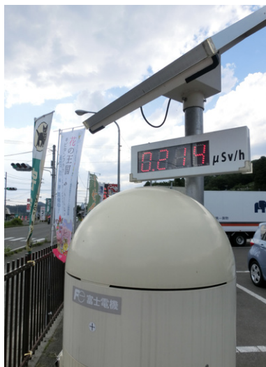
福島県川俣町 — 空間線量測定のために設置されたモニタリングポスト、2014年6月
